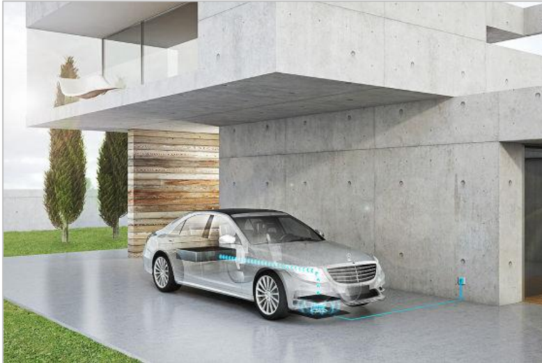
Abbildung 10: Induktive Ladetechnologie der Daimler AG (27)
